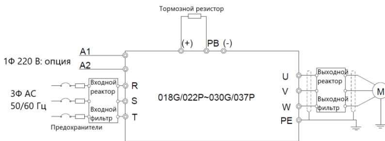
Рис. 4-8 Схема подключения силовых цепей для моделей 018G/022P~030G/037P
